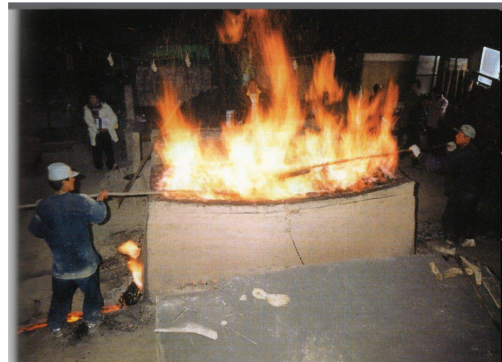
2. たたら炉と操業 島根県仁多郡奥出雲町で現在も行われている「日刀保たたら」。
